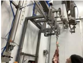
Système de descente de carcasses, pneumatique, en acier inoxydable
