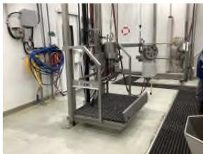
Poste de coupage des carcasses, hydraulique, en acier inoxydable comprenant:
