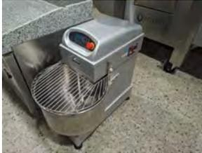
Pétrin à spirale robuste, électrique, en acier inoxydable
