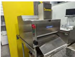
Façonneuse à pâte automatique, en acier inoxydable
