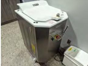
Diviseur à pâte hydraulique / électrique, sur roues
